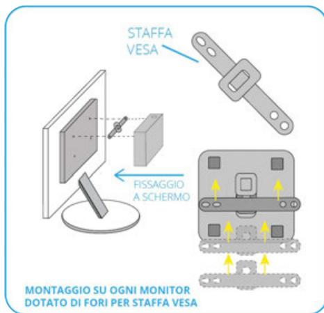
Activa IOT è predisposto per il fissaggio a monitor, a parete, o all'interno di device multimediali tramite il supporto **standard VESA** di serie: in uno spessore ridottissimo, il sistema di aggancio e sgancio rapidi consentono un fissaggio sicuro.
